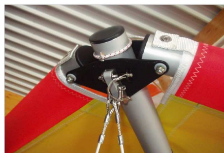
Voile racing 190 grammes Tube Zical 7075 T6 anodisé
